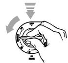
• Appuyer sur le bouton de commande et le tourner vers la gauche (sens antihoraire) jusqu'au réglage désiré dans la zone marquée "SINGLE".
